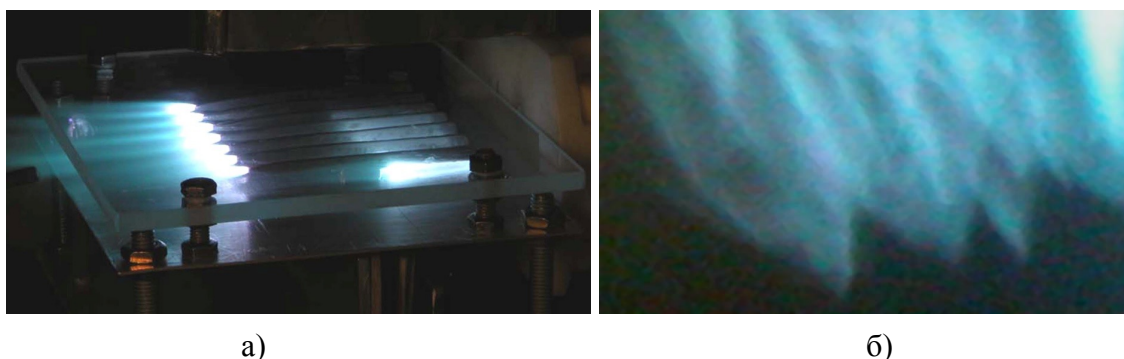
Рис.4 - Устойчивое горение пропана в плоском сверхзвуковом потоке (а). Фронт горения (б) совпадает с линиями распространения возмущений в сверхзвуковом потоке с M=2 .
