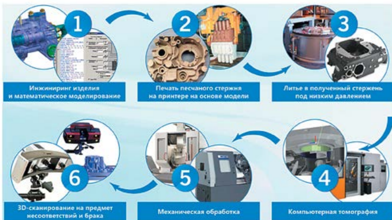
Рис. 2. Пример сокращенной технологической цепочки промышленного производства изделия по аддитивным технологиям
