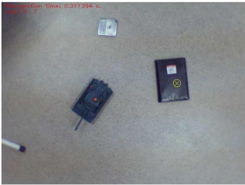
Рис. 10: Входное изображение с камеры, присутствуют конкурирующие контуры. Порог равен 7, центр цели определен ошибочно — выбран конкурирующий объект.
