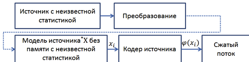
Рис. 1. Типовая схема кодирования реальных данных
