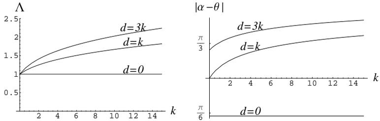
Рис. 2: Зависимость  $\Lambda$  и угла  $|\alpha - \theta|$  от относительной жёсткости армирования  $k$
