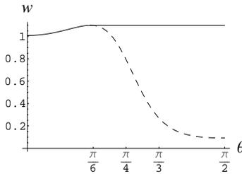
Рис. 6: Зависимость деформации  $w$  от угла намотки нитей  $\theta$ .
