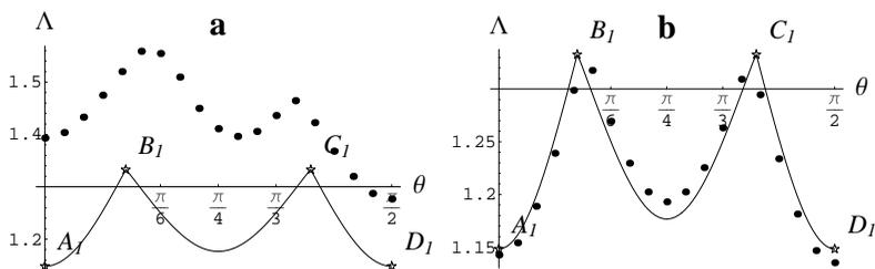
Рис. 4: Зависимость критической нагрузки от угла армирования.
